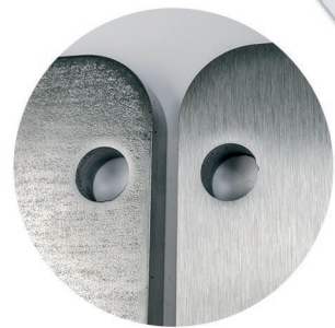
Final surface polishing Polieren der Oberfläche Ontbramen en slijpen
